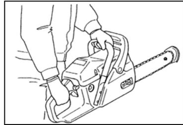
Haga arrancar el motor, fíjese que esté funcionando correctamente. Apriete el gatillo para abrir completamente la aceleración y empiece el corte. Si la cadena está afilada correctamente, el corte exigirá relativamente poco esfuerzo. No es necesario empujar hacia abajo con mucha fuerza para hacer que la sierra corte. Si la sierra se empuja con mucha fuerza se disminuirá la velocidad del motor y, en realidad, se dificultará el corte.
